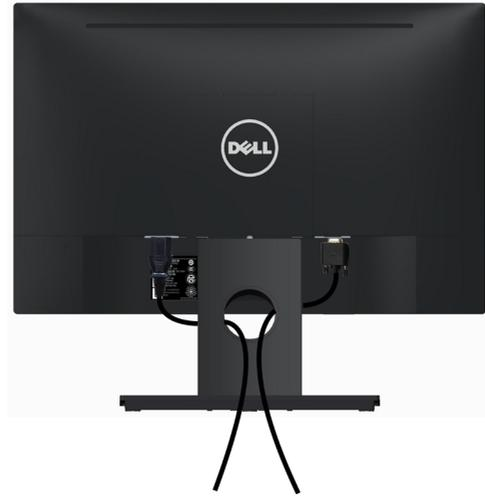
Nachdem Sie alle erforderlichen Kabel an Monitor und Computer angeschlossen haben, (für Kabelanschlüsse siehe [Ihren Monitor anschließen](#)) verlegen Sie alle Kabel so, wie oben dargestellt ist.
