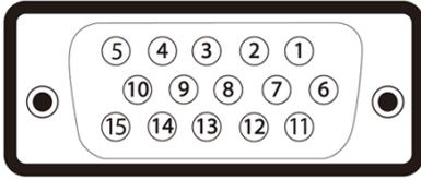
**Pin-Nummer** 15 polig Seite des angeschlossenen Signalkabels
